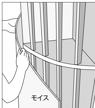
円形柱への施工(下地施工)
