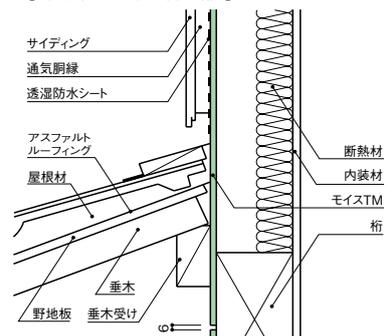
※建物の居住性・耐久性を高めるため、外壁の施工には通気工法をおすすめします。
