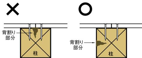
・柱の背割り部分にモイスTMを取付けないようにしてください。
